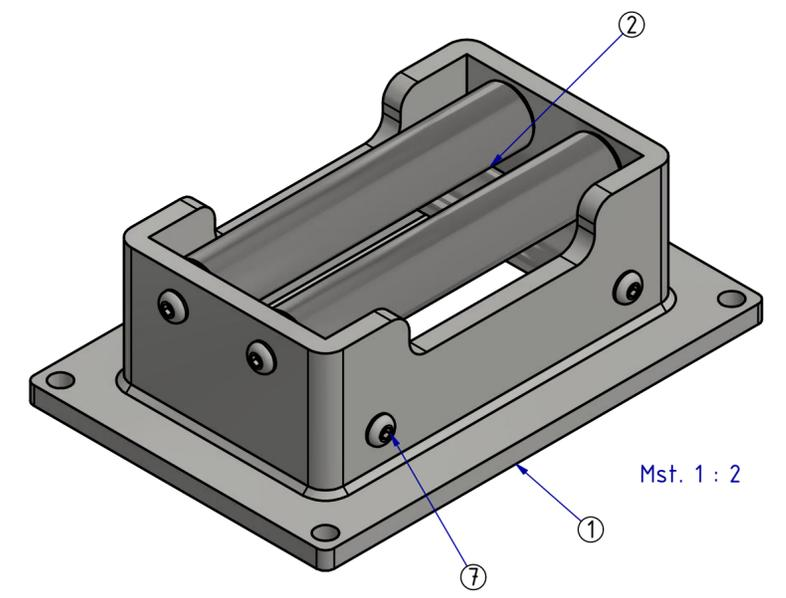
Seilfenster zum zentrierten Führen von Drahtseilen in einem bestimmten Breitenbereich bei Seilwinden.
