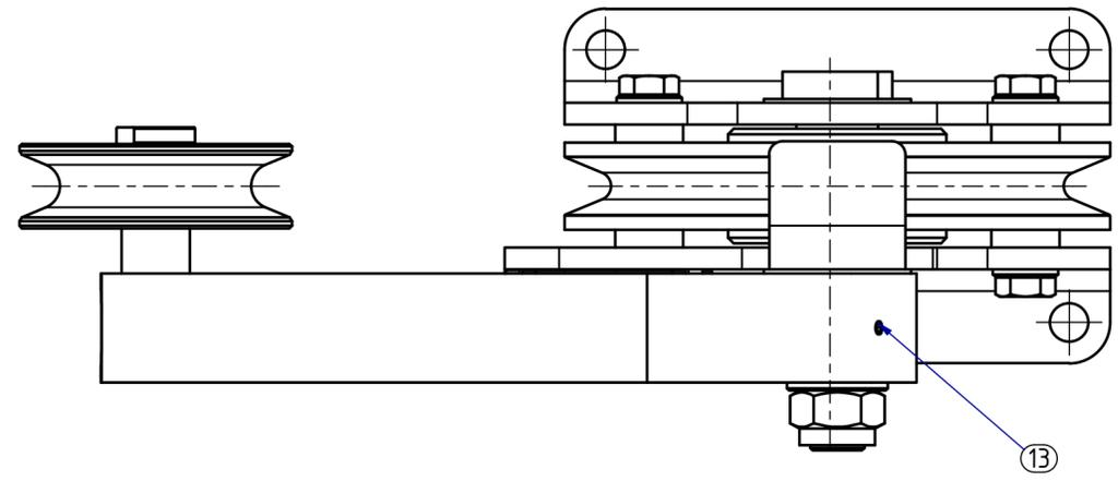
Zur Überwachung von Seilen, die unter Spannung in Rollen geführt werden.
