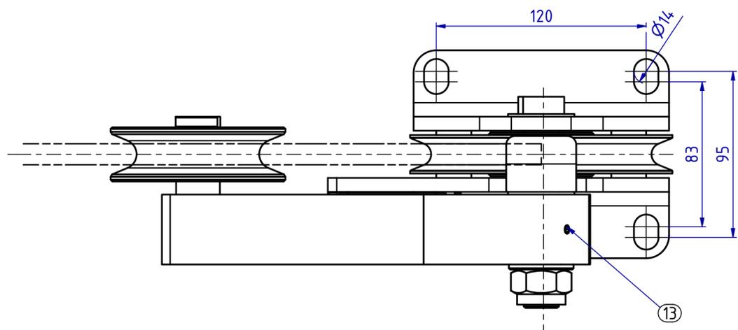
Zur Überwachung von Seilen, die unter Spannung in Rollen geführt werden.
